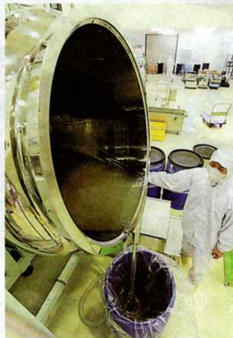
真空乳化装置と呼ばれる巨大な釜から ジェルが取り出される
